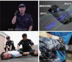
该手套还有一个突出优点，那就是杨云龙教官首创的鞋压开关控制与可调节的脉冲模式相结合，确保使用者可以调节电击模式和任意控制电击时间。民警在使用该手套抓累嫌疑人手脚时，利用低电流高压脉冲对肌肉神经进行干扰，使嫌疑人被手套控制部分的肌肉收缩痉挛，2-3 秒内失去反抗能力。由于脉冲控制通常只作用在手部部位，远离人体心脏、大脑等重要器官，因此使用上比美国泰瑟电击枪更加安全可靠。
